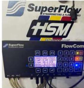
Gambar 9. Hasil Pengukuran Jumlah Aliran Bahan Bakar Sampel A Menggunakan *Flow Bench*
