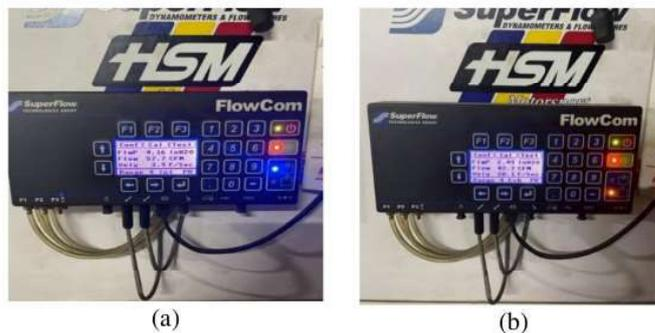
Gambar 3. Pengukuran *Airflow*, (a) Saluran Isap (*Intake*) dan (b) Saluran Buang (*Exhaust*)
