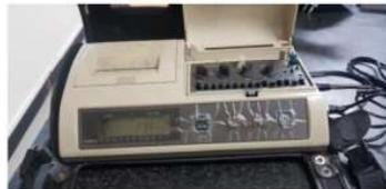
Gambar 2. Alat Ukur Kekasaran Permukaan Mitutoyo SurfTest SJ-301 dengan Kecermatan 0,02  $\mu\text{m}$
