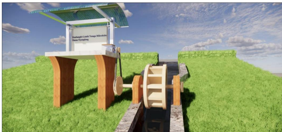
Gambar 4. Pembangkit Listrik Tenaga Mikrohidro
