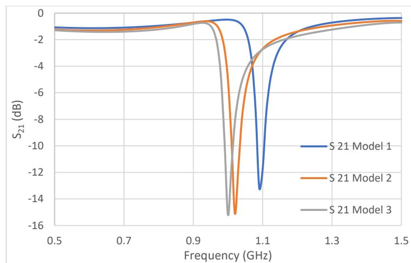
**Gambar 7.** Frekuensi Resonansi Pengembangan Model Sensor Gelombang Mikro
