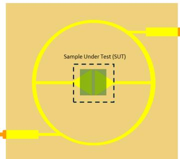
**Gambar 9.** SUT Diletakan pada *Sensing Area*
