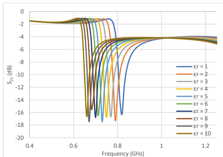
**Gambar 21.** Parameter  $S_{21}$  Iterasi 3 pada sensor diletakan SUT
