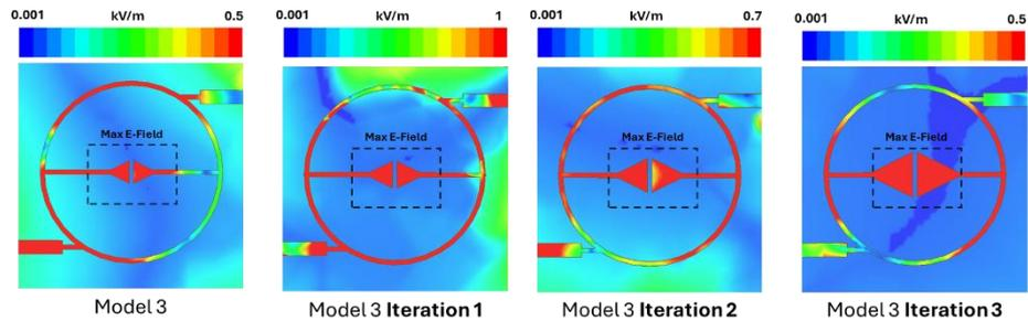
**Gambar 18.** *E-Field* Iterasi Sensor Gelombang Mikro
