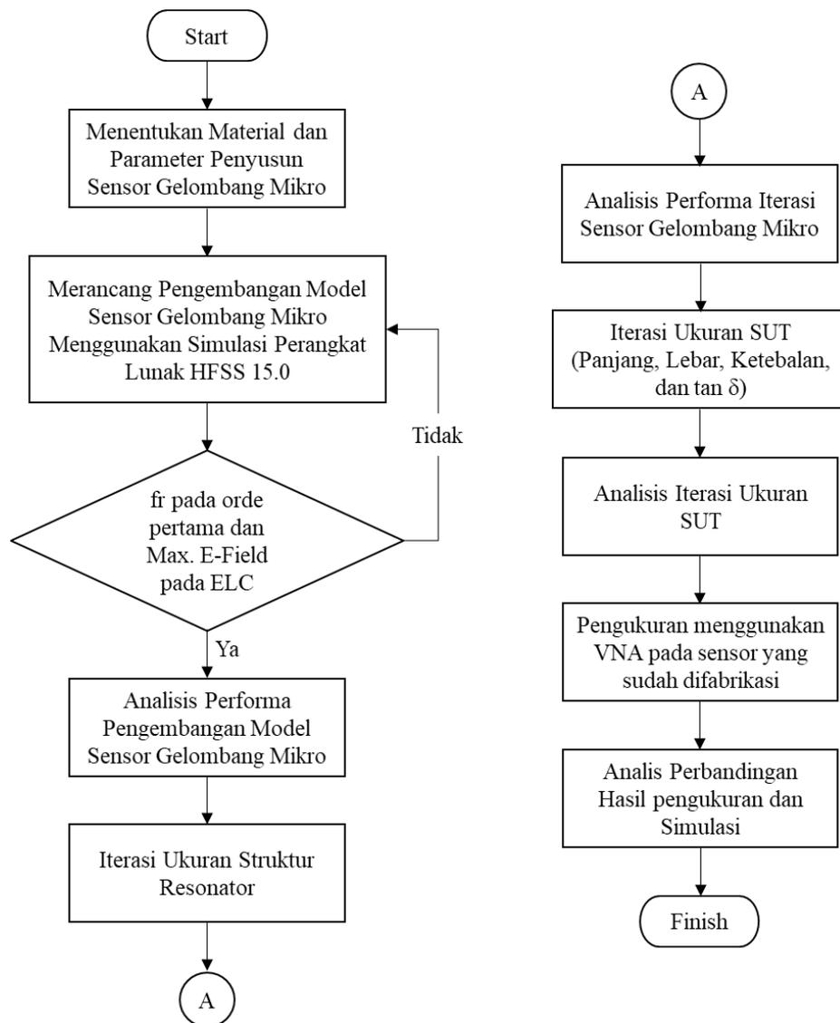
**Gambar 3. Diagram Alir Perancangan Sensor Gelombang Mikro**
