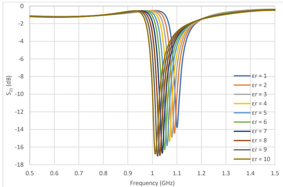
**Gambar 10.** Parameter  $S_{21}$  Model 1 pada sensor diletakan SUT
