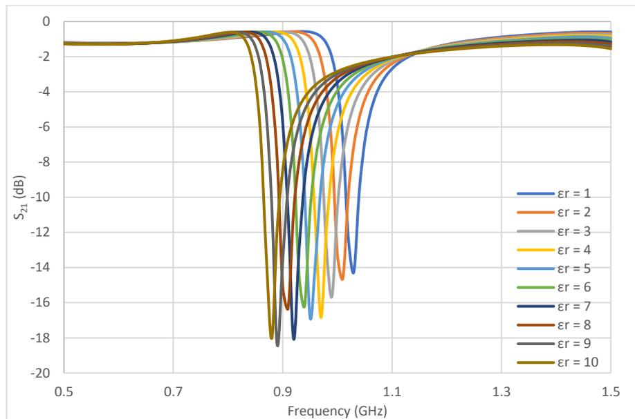
**Gambar 11.** Parameter  $S_{21}$  Model 2 pada sensor diletakan SUT
