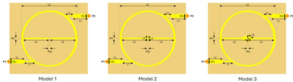
**Gambar 6.** Detail Dimensi Pengembangan Model Sensor Gelombang Mikro
