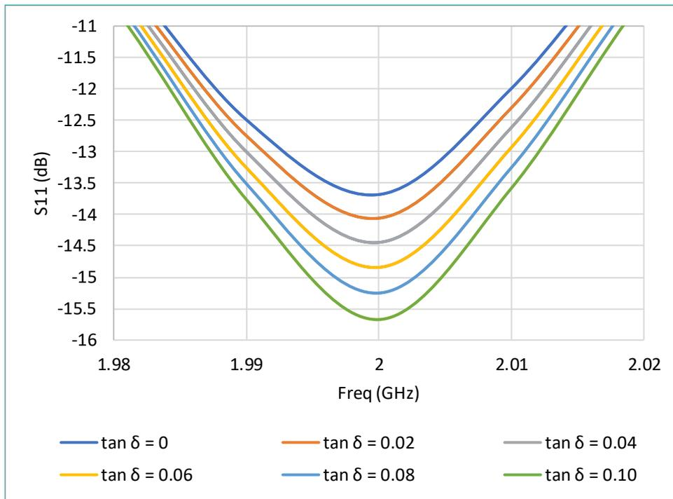
**Gambar 28. Hasil Simulasi untuk Iterasi SUT Dielektrik Tan  $\delta$**
