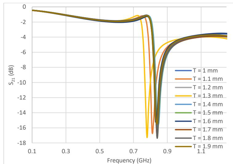
**Gambar 33.** Frekuensi Resonansi Iterasi Ketebalan SUT
