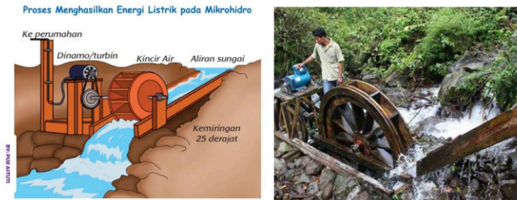
Gambar 2. Pembangkit tenaga listrik mikrohidro (PLTM)
