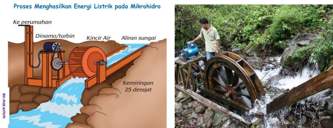
Gambar 2. Pembangkit tenaga listrik mikrohidro (PLTM)
