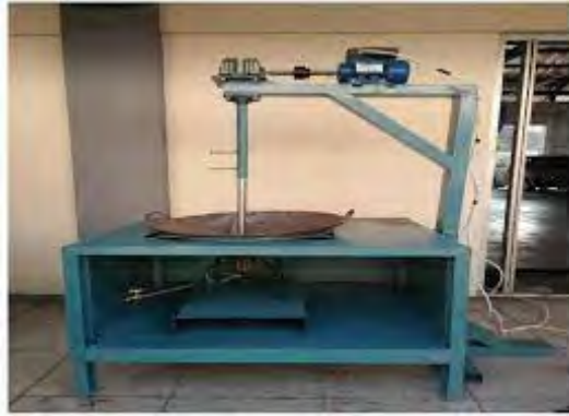
Gambar 30. Mesin Pengaduk Dodol Karangampel (Sifa et al., 2020)
