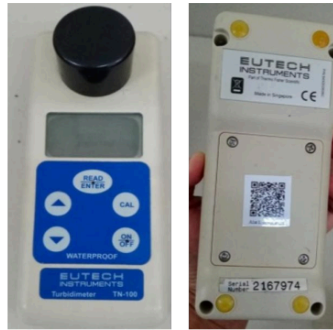
Gambar 7. Alat Turbidimeter Mengukur Kekeruhan Air
