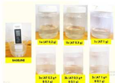
Gambar 5. Hasil percobaan variasi massa menggunakan ampas tebu, kombinasi bentonite dan ampas tebu
