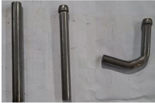
Gambar 4.13 Proyek D37 exhaust hanger, benda kerja sebelum proses (kiri), hasil proses upsetting(Tengah), hasil proses bending (kanan)
