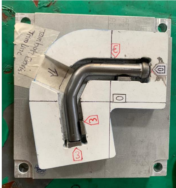
Gambar 4.19 Pemeriksaan Produk Proyek D37 Exhaust Hanger Setelah Perbaikan
