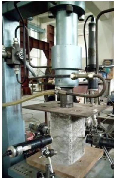
Gambar 5.36. Tekstur permukaan kubus beton polystyrene untuk pengujian modulus elastis
