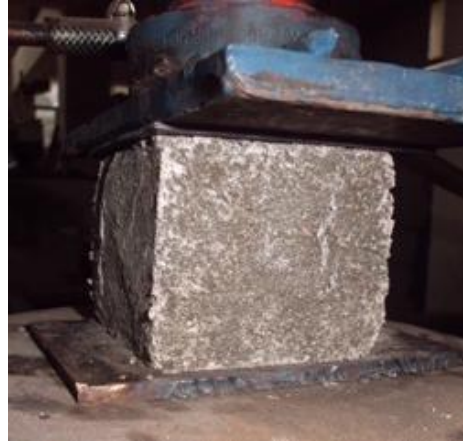
Gambar 5.38. Pola keruntuhan benda uji kubus beton polystyrene
