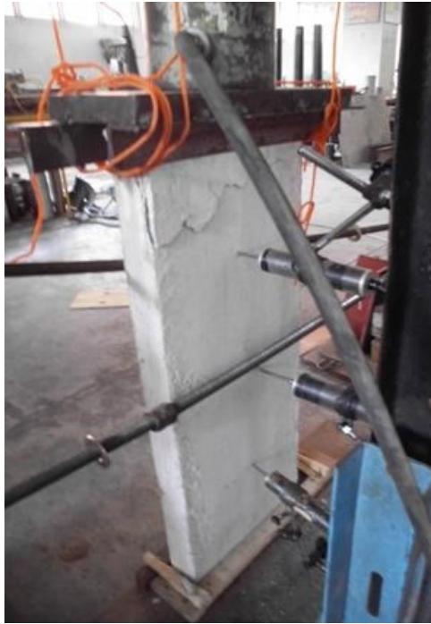
Gambar 5.31. Tipe kerusakan akibat uji tekan panel dinding polystyrene PST2_300
