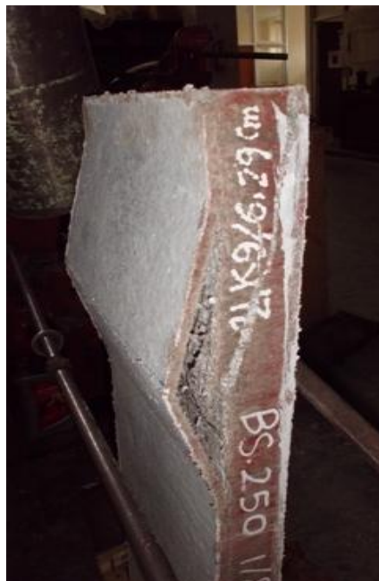
Gambar 5.27. Tipe kerusakan akibat uji tekan panel dinding polystyrene PST3_250
