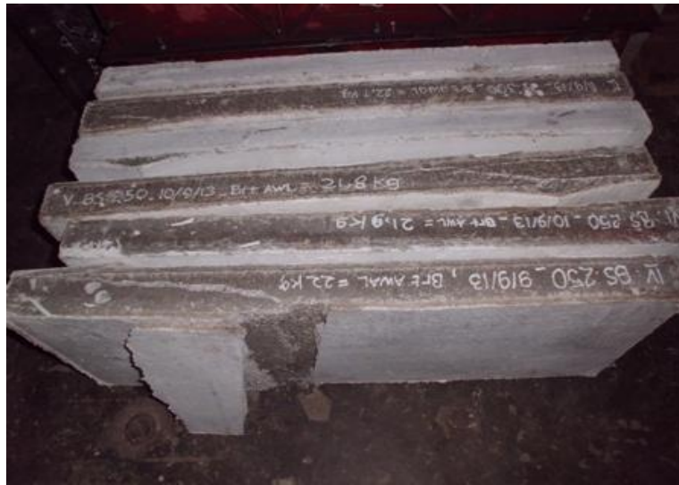
Gambar 5.34. Tipe kerusakan akibat uji tekan panel dinding polystyrene PST1_250 sampai PST3_300
