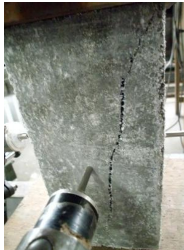
Gambar 5.39. Pola keruntuhan benda uji modulus elastis
