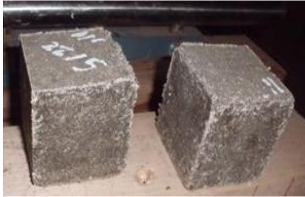
Gambar 5.35. Tekstur permukaan kubus beton polystyrene untuk pengujian kuat tekan dan penyerapan
