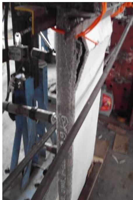
Gambar 5.33. Tipe kerusakan akibat uji tekan panel dinding polystyrene PST3_300
