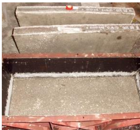
Gambar 5.37. Tekstur permukaan panel dinding beton polystyrene untuk pengujian tekan dan lentur
