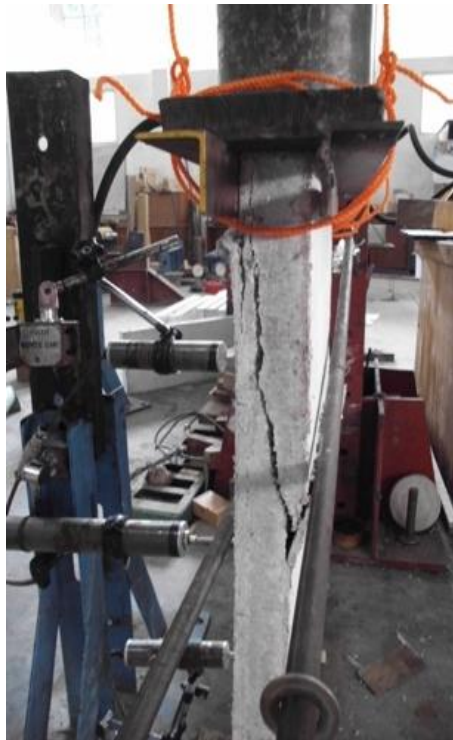
Gambar 5.25. Tipe kerusakan akibat uji tekan panel dinding polystyrene PST2_250
