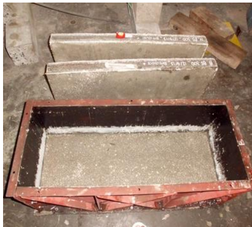
(b) Panel beton polystyrene setelah 24 jam dan siap untuk dilepas
