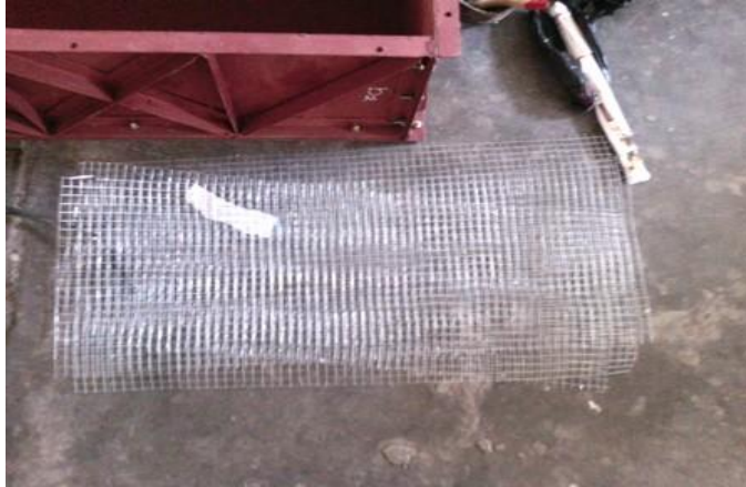
Gambar 4.16. Kawat Locket \phi 0,7 mm, grid 12,5x12,5 mm
