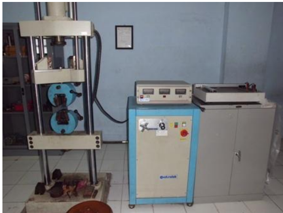
Gambar 4.4. Alat uji kawat koket
