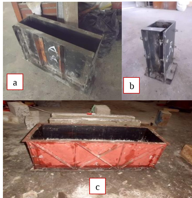
Gambar 4.6. (a) Bekisting baja balok, (b) Bekisting baja kubus, dan (c) Bekisting baja plat dinding
