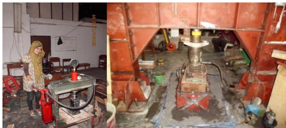
Gambar 4.8. Alat kempa kapasitas 5 Ton dan Sketsa pengempaan panel dinding polystyrene
