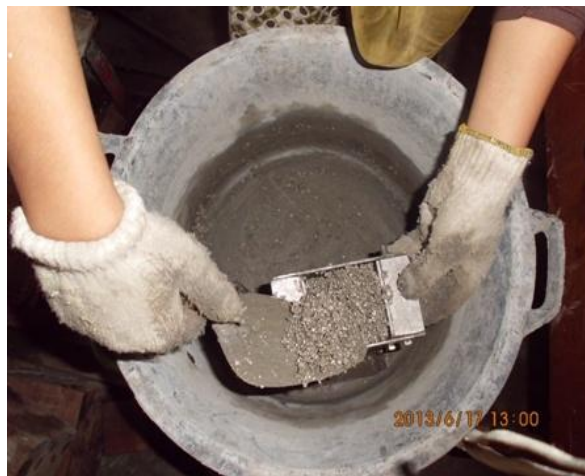
Gambar 4.19. Penuangan Beton segar kedalam cetakan benda uji
