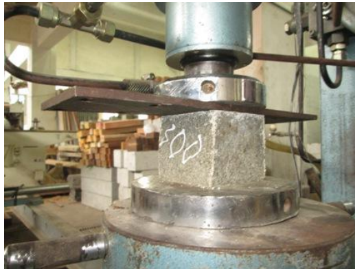
Gambar 4.24. Pengujian kuat tekan kubus
