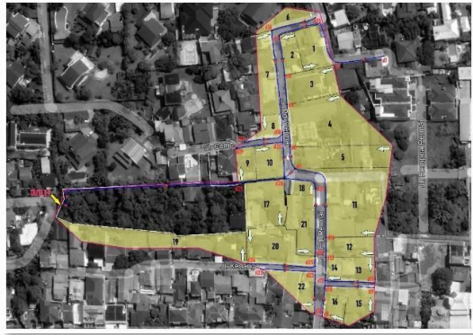
Gambar 4. DAD Townhouse dan Skema Drainase Skenario 0
