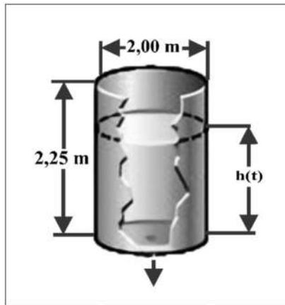
Gambar 3. 6 Tangki silinder dengan lubang kecil pada dasarnya
