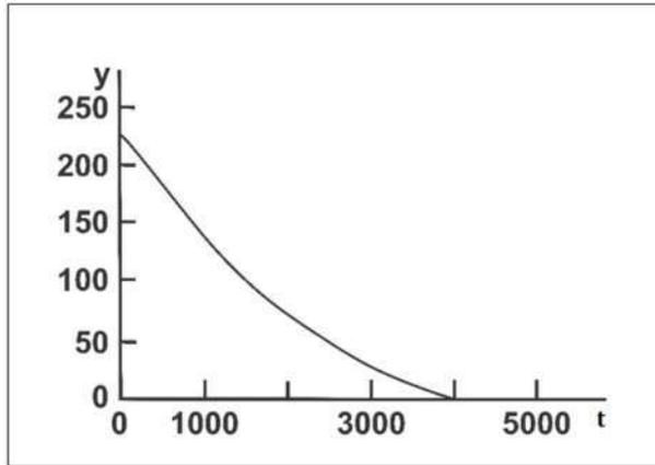
Gambar 3. 7 Grafik solusi tangki silinder dengan lubang kecil pada dasarnya
