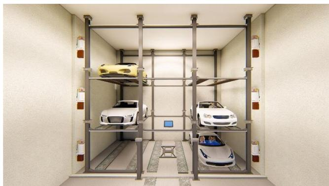
**Gambar 7.** Ilustrasi Parkir Menggunakan Sistem HAPS
